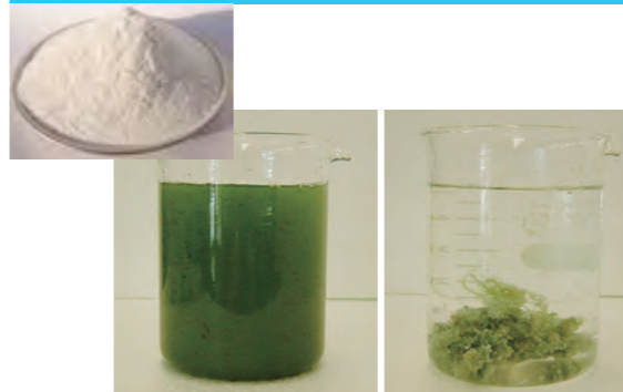
無機系凝集剤処理
